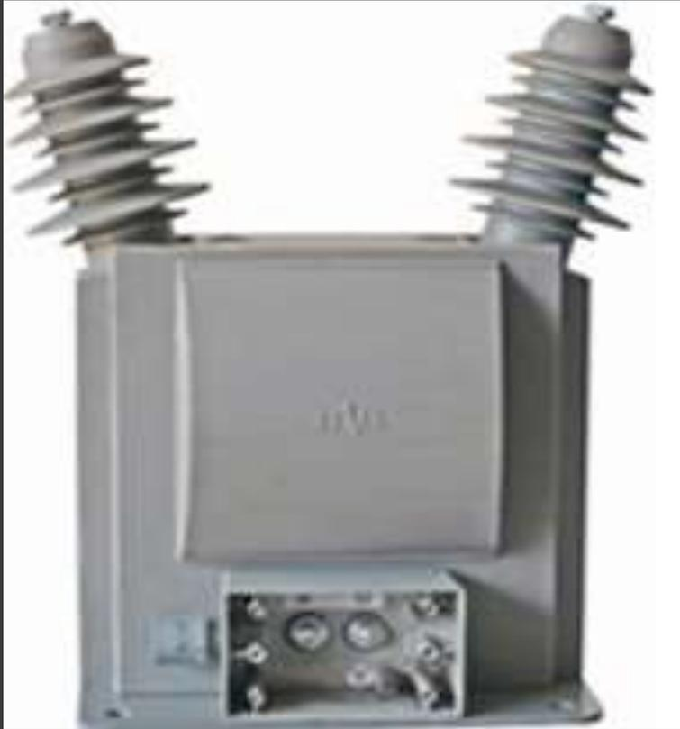
Es el transformador diseñado para suministrar la tensión adecuada a los instrumentos de medición como los voltímetros, frecuencímetros, wattmetros, wathhorímetros, etc., así como a los aparatos de protección como los relevadores; en el cual la tensión secundaria es proporcional a la tensión primaria y desfasada respecto a ella un ángulo cercano a cero.
