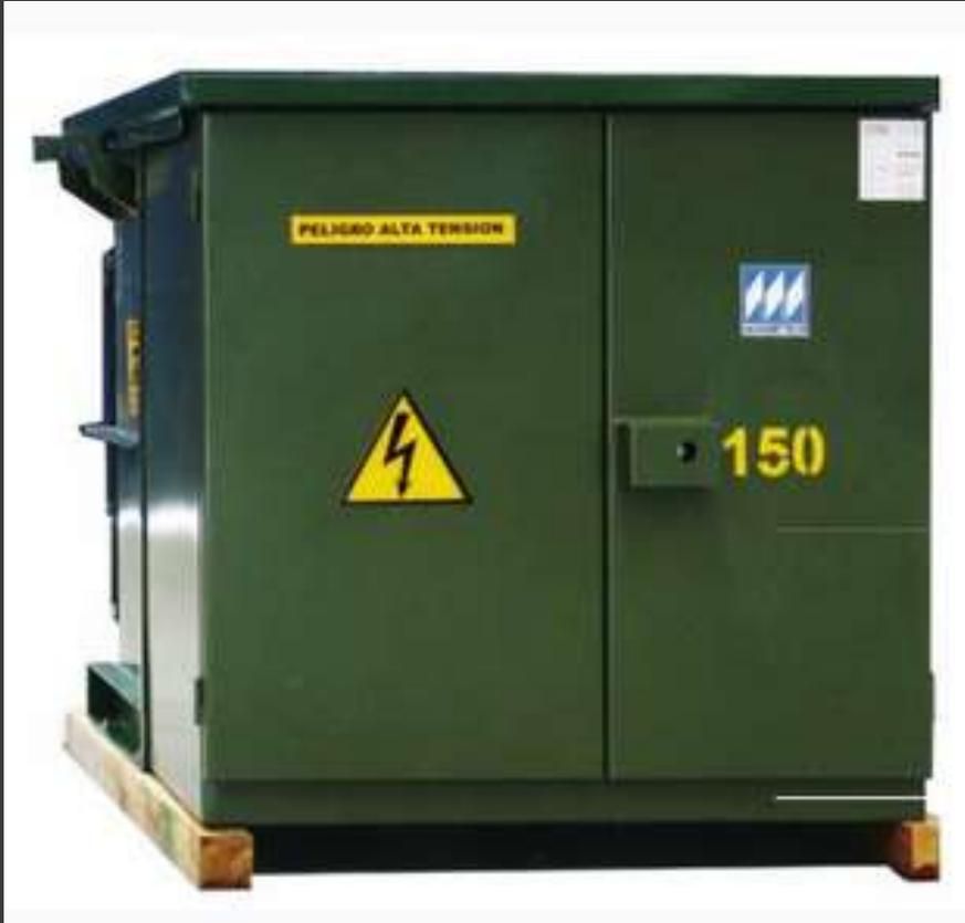
La subestación de pedestal está conformada por dos gabinetes, uno en el que se encuentra alojado el transformador el cual lleva sus protecciones internas y otro para la caja de maniobras, estos gabinetes cuentan con cerradura que impiden el ingreso de personal no autorizado. La subestación de pedestal debe contar con una puesta tierra a la que se conectan las partes metálicas de la subestación, al neutro del transformador y la tierra de los descargadores de sobretensión.
