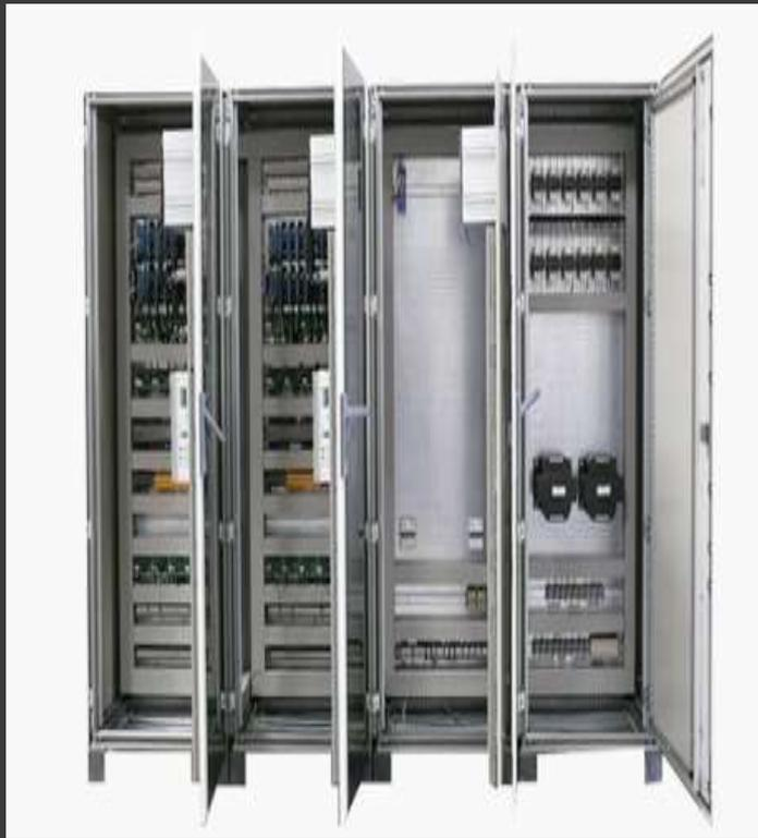
Es el conjunto de gabinetes modulares utilizados para instalar los diferentes equipos de medición, protección y mecanismos de control de la subestación, además tiene instalados los sistemas de mandos para efectuar las diferentes maniobras de control de una subestación cuando sea necesario en forma manual.
